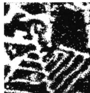
Abbildung 9. Flächenscan für ein Element (Si-Verteilung in einem binären Al-Si-Eutektikum, gemessen mittels Elektronenstrahlmikrosonde).
